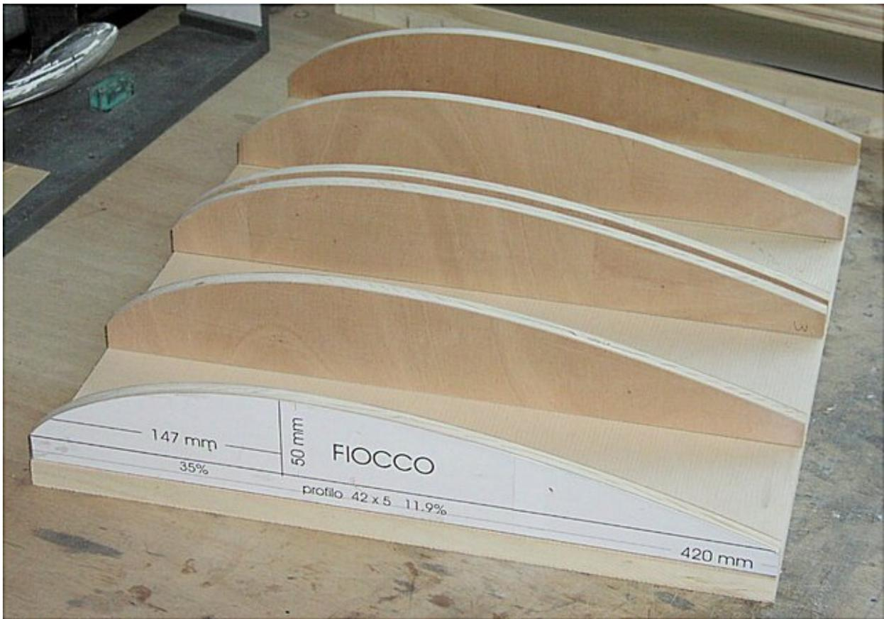
dettaglio, le due centine centrali sono montate leggermente all'interno delle basi. Questo semplice accorgimento potrebbe servire , se necessario, a rifilare i bordi delle due metà per avere un contatto perfetto.
