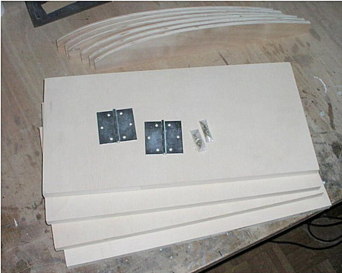
assiemaggio delle centine in compensato da 10mm .
